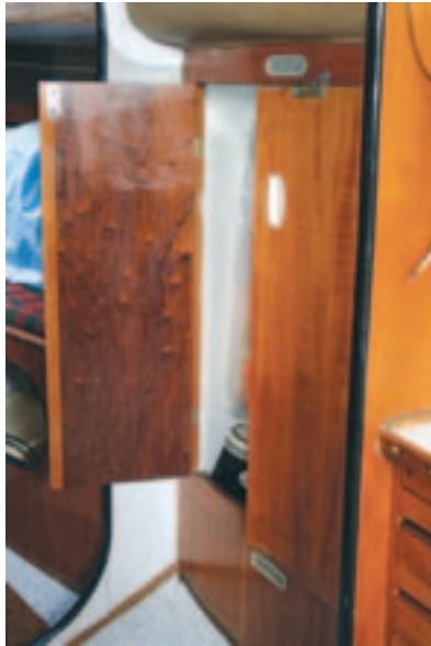
Der Ölzeugschrank im Durchgang zum Vorschiff lenzt in die Bilge und hat eine eigene Belüftung
