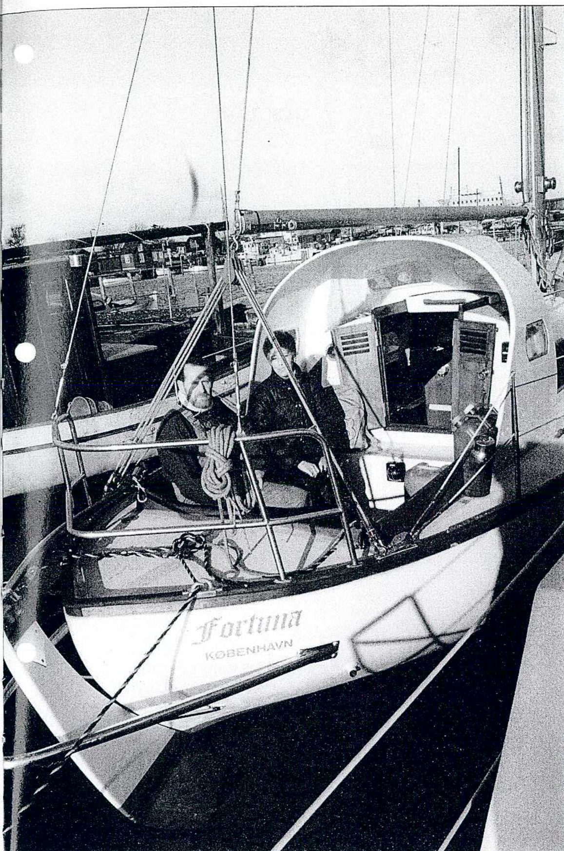
Den 20 år gamle Sagitta 30 har før verdensomsejlingen fået »kofanger« ved roret, sprayhood, bovspryd samt ekstra tanke til vand og diesel. Toilet og varmeapparat er fjernet, hvilket har givet ekstra stueplads.
